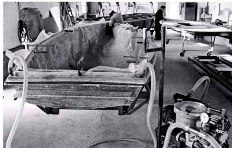
L'apparecchiatura che permette di ottenere il sottovuoto durante la stratificazione dello scafo e della coperta. Con questa operazione non si presentano fenomeni di delaminazione della struttura a sandwich.
