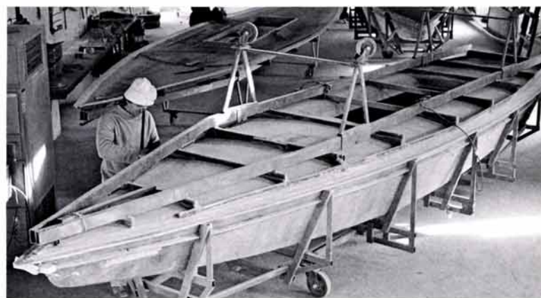
Lo stampo dello scafo della Star (a sinistra) con "l'anima" del sandwich, come si presenta dopo l'incollaggio sottovuoto. Ultimata la stratificazione di scafo e coperta (sopra) i due stampi vengono uniti per procedere all'assemblaggio.
