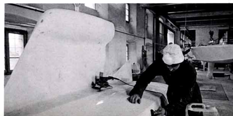
Lo stampo dello scafo della Star (a sinistra) con "l'anima" del sandwich, come si presenta dopo l'incollaggio sottovuoto. Ultimata la stratificazione di scafo e coperta (sopra) i due stampi vengono uniti per procedere all'assemblaggio.
